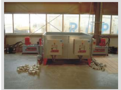
RB 160 Spezial, Tandem Brikettierpresse mit großem Behälter
